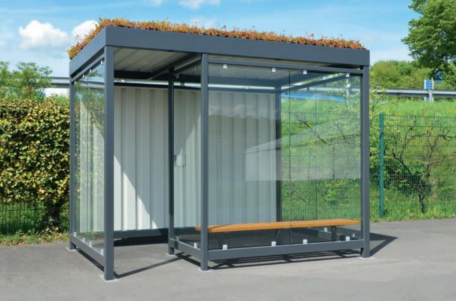
Raucherunterstand LEONIS GREEN mit auftragsbezogener Anpassung (zusätzliche Windschutzwand), Dachbreite x Dachtiefe 3180 mm x 2165 mm, Rückwand Trapezblech, Seiten- und Windschutzwände, ESG, Klarglas, Sitzbank, Stahlkonstruktion in RAL 7016 anthrazitgrau
